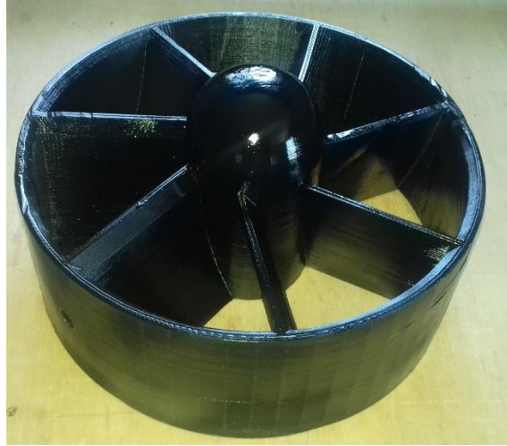
F2. Construcción del cuerpo de la turbina
