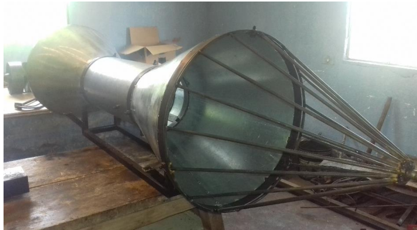
F2. Construcción del cuerpo de la turbina
