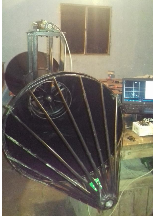
Anexo G. Montaje de la turbina y medición de datos en el canal
