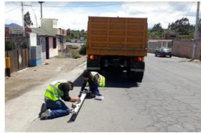
Viga armada y colocada para el ensayo
