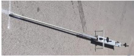
Viga Benkelman armada
