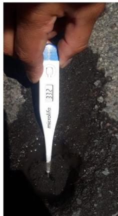
Toma de temperatura del asfalto
