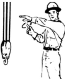
**MOVER LENTAMENTE:** usar una mano para dar cualquier señal de movimiento y por otro lado colocar una mano inmóvil delante de la mano en movimiento
