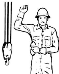
**DESPLAZAMIENTO (una oruga):** bloquear la oruga del lado indicado por el puño levantado. El desplazamiento del otro lado del puño, haciéndola girar verticalmente ante el cuerpo. (sólo para grúas de tierra).
