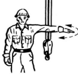
**PARADA:** brazo extendido, palmas abajo, y mover el brazo de atrás hacia adelante en forma horizontal.
