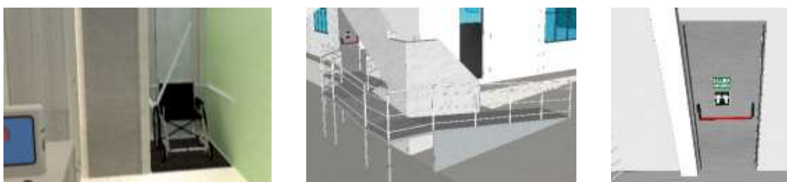
Imagen 43: Plataforma vertical salva escleras - Plataforma vertical salva escleras – Puerta de emergencia
