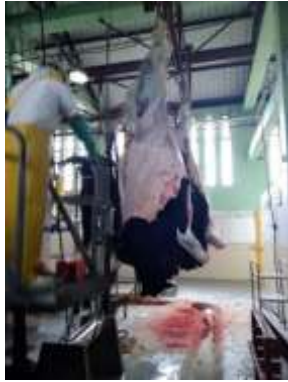
Imagen 11: Desprendimiento mecánico del cuero 1
