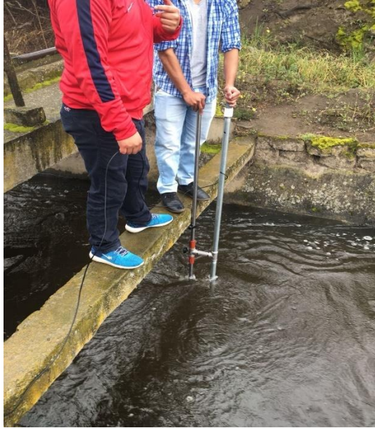
Prueba en campo del eje utilizado para alcanzar las profundidades de medición del 20%, 60% y 80% del calado.
