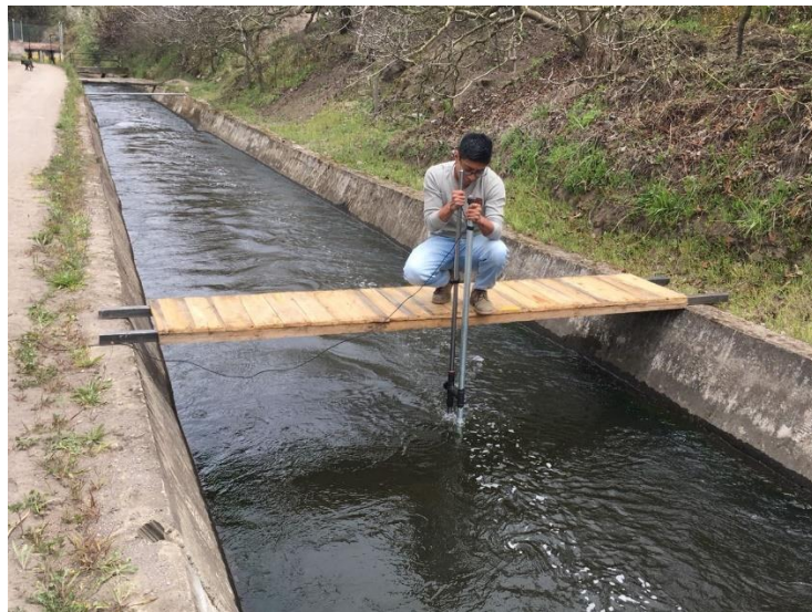
Registro de datos de velocidad en los puntos requeridos a lo largo del tramo en estudio con la utilización de una plataforma
