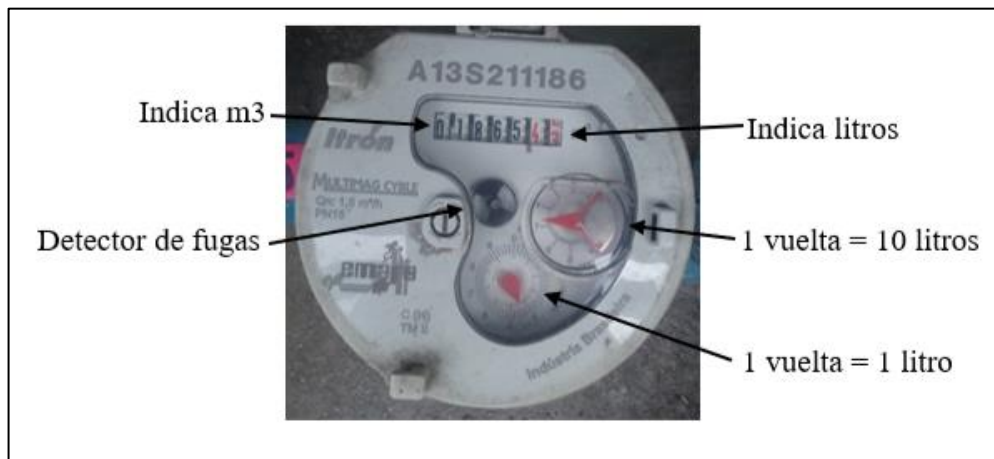
Gráfico 10. Como leer un medidor de agua potable.
