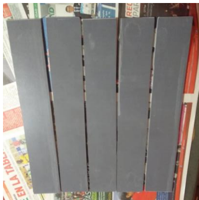
Figura 3.12 Probetas cortadas, lijadas y medidas [Autor]
