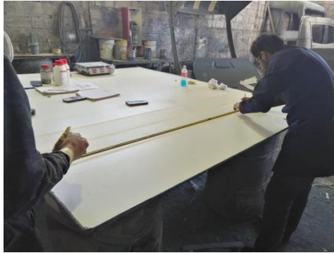
Figura 3.2 Medición y delimitación del molde [Autor]
