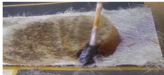
Figura 3.9 Aplicación de la resina en la capas de fibra [Autor]
