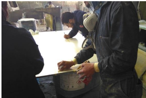
Figura 3.3 Aplicación de la cera en el molde [Autor]
