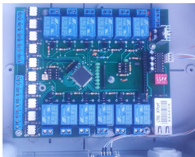
Fig. 2.10. Tarjeta de control del sistema actual basado en microcontrolador Fuente: El investigador
