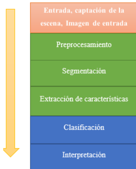
Figura 21: Etapas de un Sistema de Visión por Computador Elaborado por: Investigador
