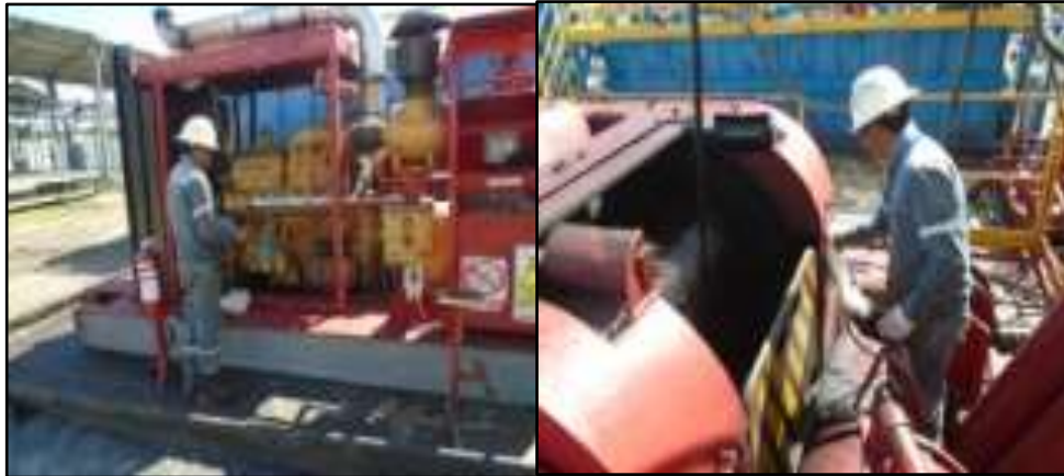
Imagen 11: Mecánico – Revisión de motores y estado del malacate
