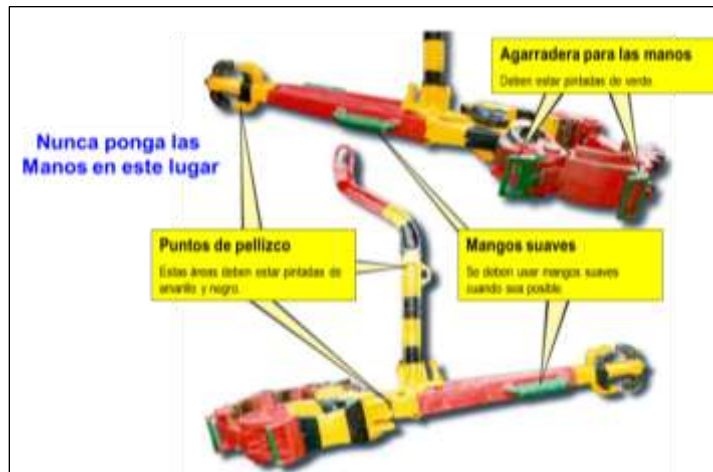
Imagen 28: Identificación y señalización de llaves de potencia
