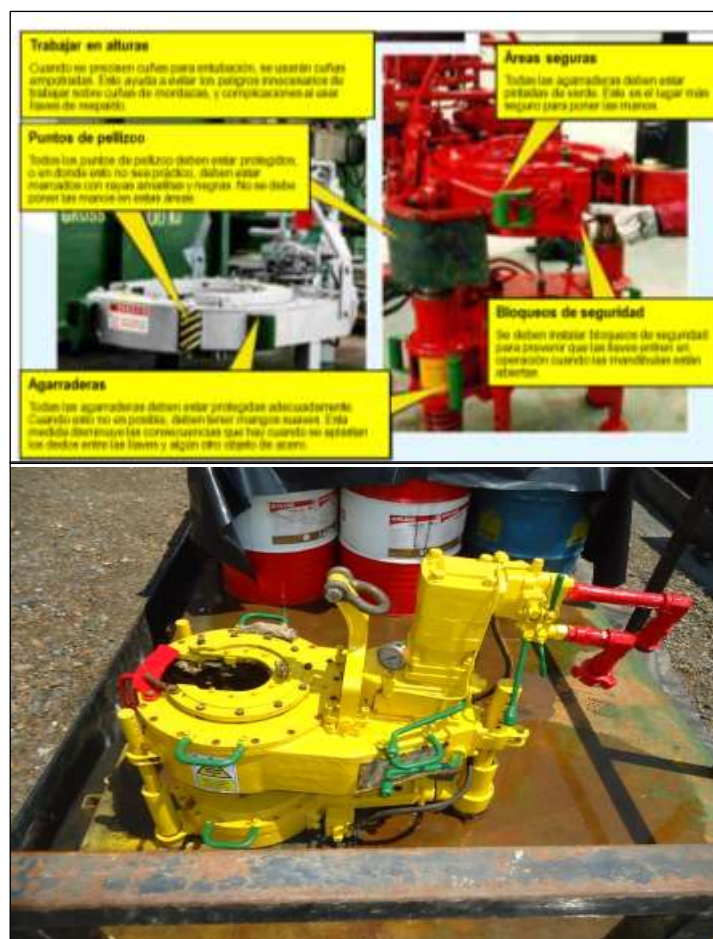
Imagen 29: Identificación y señalización de llaves de enrosque
