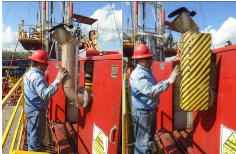
Imagen 30: Protección e identificación de partes calientes
