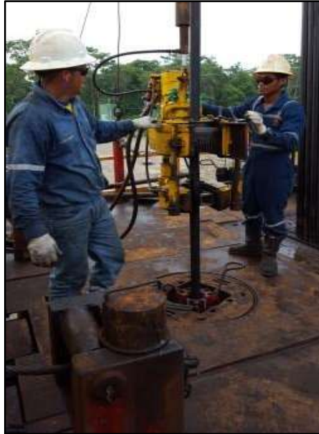
Imagen 9: Cuñeros realizan conexión de tubería en el Rig Floor
