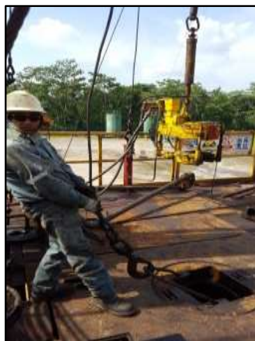
Imagen 3: Acción subestándar Izaje inseguro, mal uso de gancho
