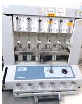
Figura 8. Equipo utilizado durante la extracción de grasa.
