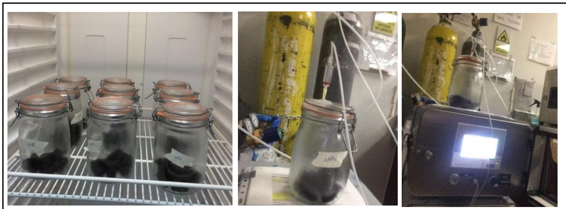
Figura 8. Medición de la concentración gaseosa para la determinación de la tasa respiratoria
