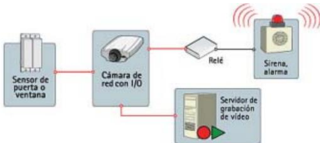
Figura 6.34: Conexión de sensores externos
