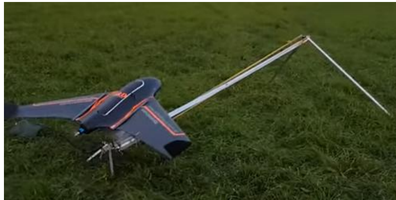
Figura 13 Plataforma de lanzamiento compacta
