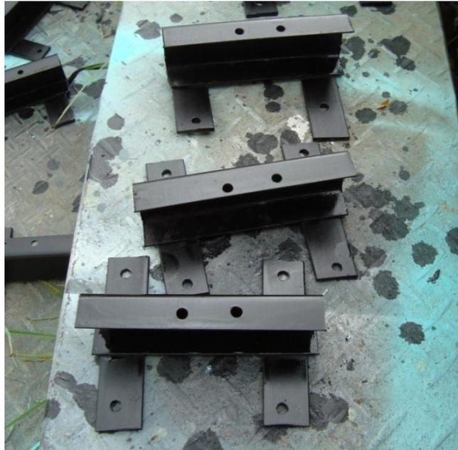
Figura N° 34. Soportes para tubería de 1/2" a 3/4"
