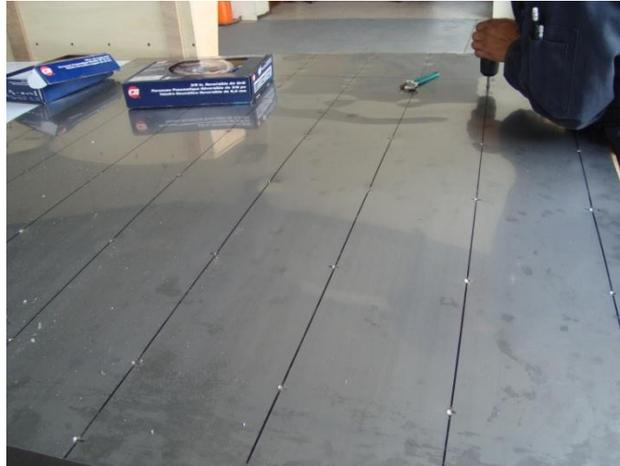
Figura N° 42. Construcción de cubierta para molde de ala
