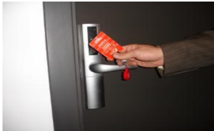
Fig. 2.17 Lector de tarjetas de proximidad mediante RFID
