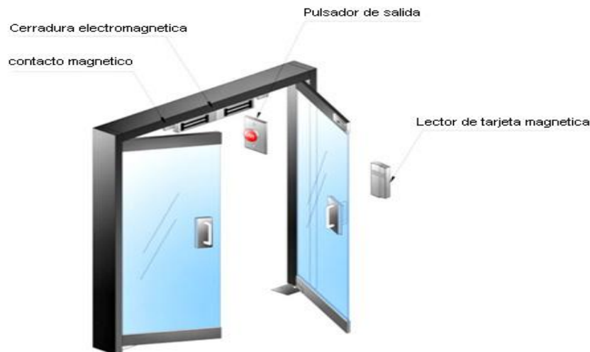
Fig. 6.11 Barrera de control mediante cerraduras electromagnéticas
