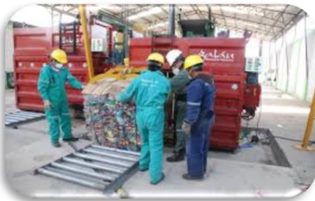
COMPACTACIÓN DE RESIDUOS INORGÁNICOS
