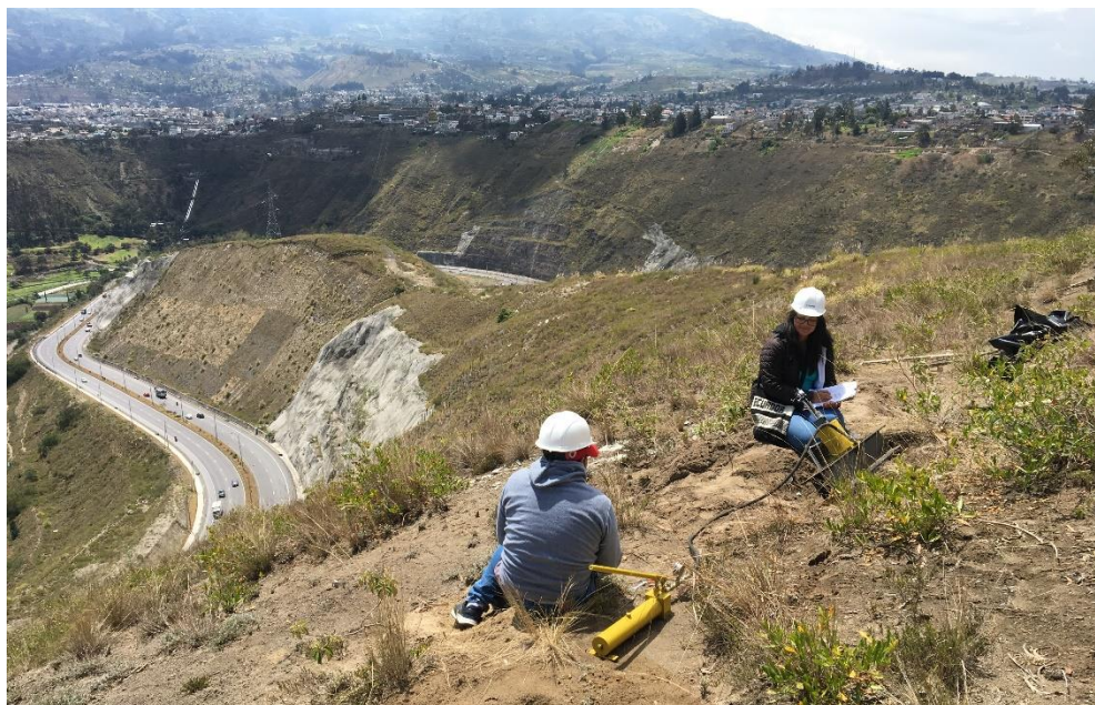
Figura 44 Registrando los desplazamientos del anclaje.
