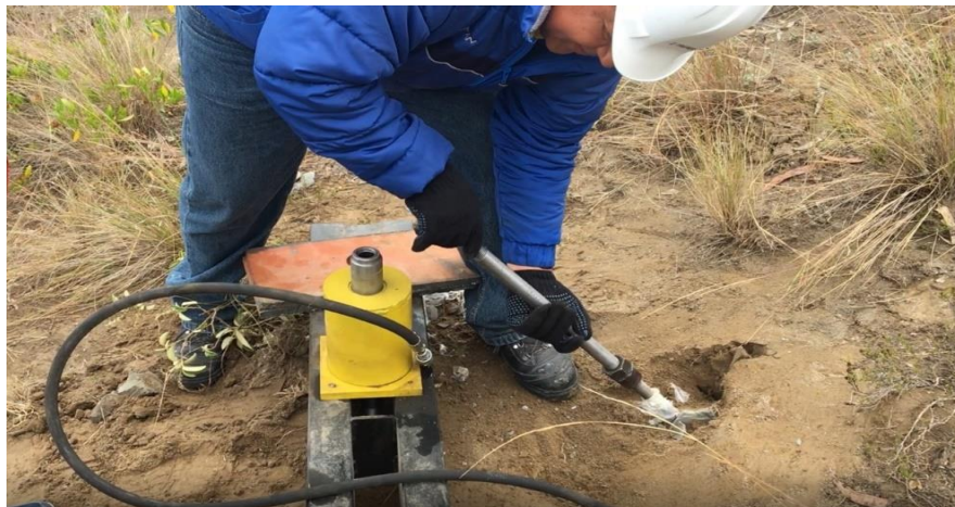
Figura 34 Acople del vástago al anclaje.
