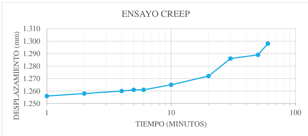
Figura 65 Ensayo creep del anclaje#6 en la segunda carga.
