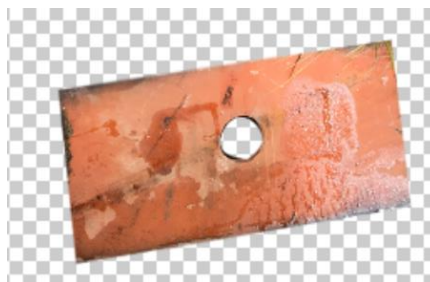
Figura 27 Placas de apoyo
