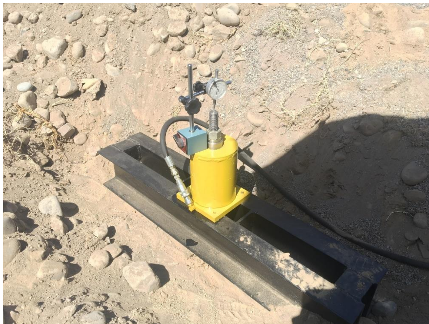
Ensayo sin placas de soporte en banco de pruebas
