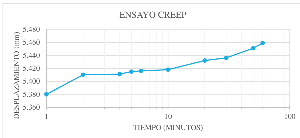
Figura 54 Ensayo creep del anclaje#3 en la primera carga.
