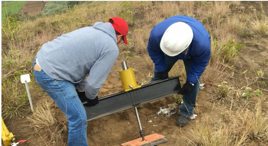
Figura 36 Colocación del equipo sobre las placas de apoyo
