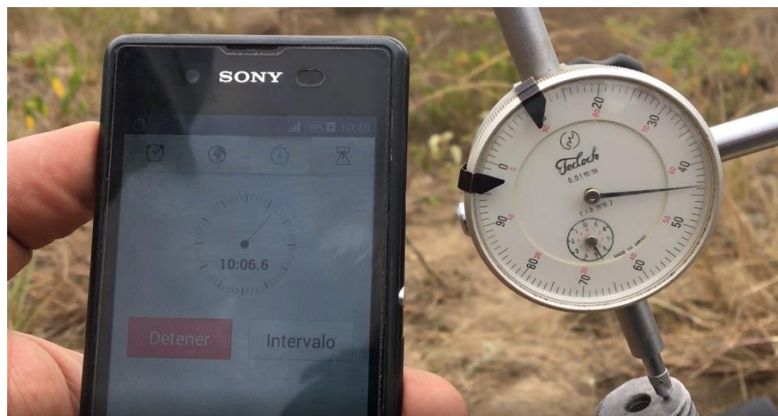
Figura 43 Tomando lectura a los 10 minutos de un paso de carga
