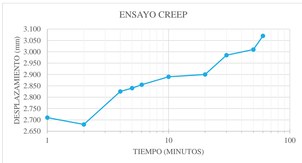
Figura 46. Ensayo creep del anclaje#1 en la primera carga
