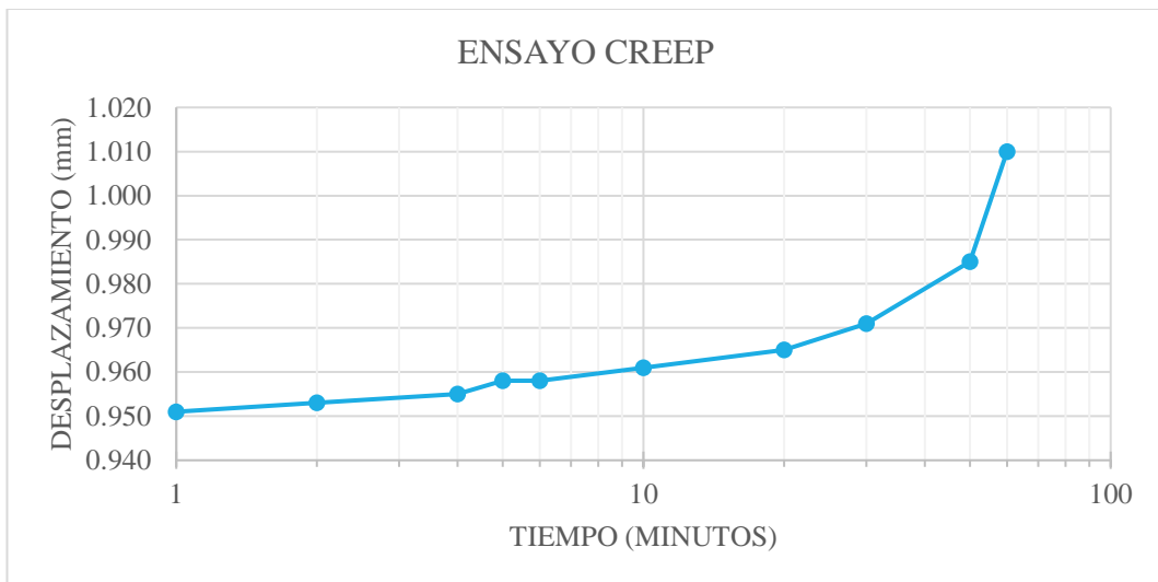
Figura 52 Ensayo creep del anclaje#2 en la segunda carga
