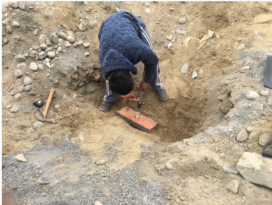
Ubicando las placas una sobre otra en banco de pruebas
