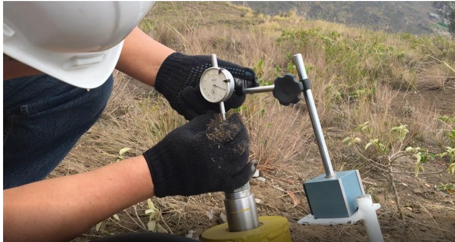
Figura 42 Colocando y encerando el reloj comparador.
