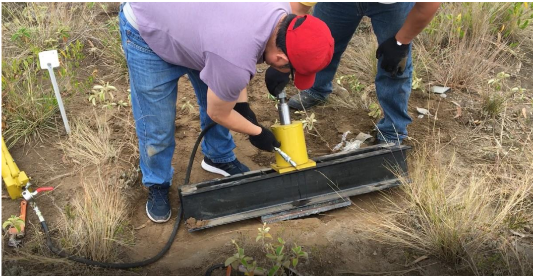
Figura 38 Conexión de la manguera al gato hidráulico.
