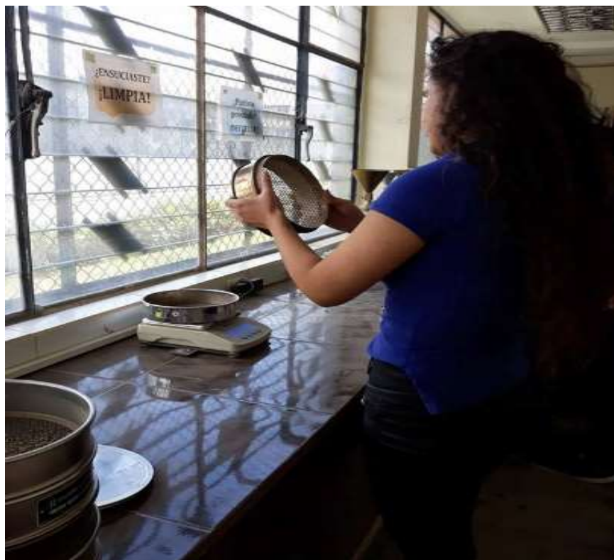
Fotografía 6. Pesaje de las porciones de muestra de suelo retenidas en cada tamiz.
