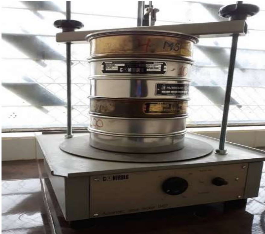
Fotografía 5. Ensayo granulométrico a las muestras de suelo.
