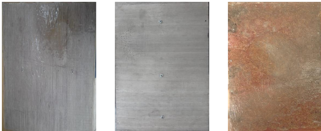
Figura 16 Probetas en orden izquierda - derecha: híbrido compuesto matriz poliéster reforzado con fibra vidrio más cabuya, híbrido compuesto matriz poliéster reforzado con fibra de vidrio más abacá y compuesto matriz poliéster reforzado con fibra de coco.
