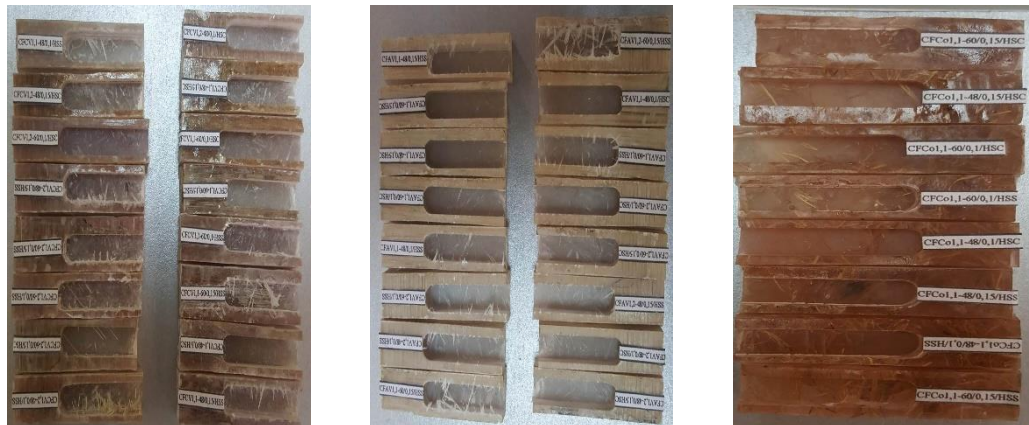
Figura 24 En orden de izquierda a derecha, probetas para la medición de delaminación en el microscopio de barrido SEM del híbrido compuesto matriz poliéster reforzado con fibra de vidrio más cabuya, híbrido compuesto matriz poliéster reforzado con fibra de vidrio y abacá y compuesto matriz poliéster reforzado con fibra de coco.
