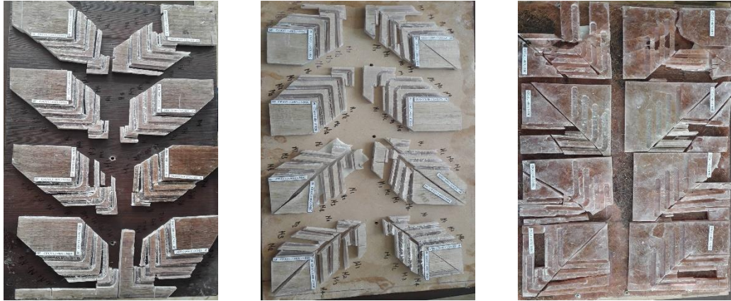
Figura 21 En orden de izquierda a derecha, probetas cortadas posterior a medición de la rugosidad del híbrido compuesto matriz poliéster reforzado con fibra de vidrio más cabuya, híbrido compuesto matriz poliéster reforzado con fibra de vidrio más abacá y compuesto matriz poliéster reforzado con fibra de coco.
