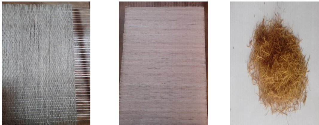
Figura 15 En orden izquierda - derecha: tejido plano 0^\circ fibra de cabuya, tejido plano 0^\circ fibra de cabuya y fibra de coco 0,5-1cm al azar.
