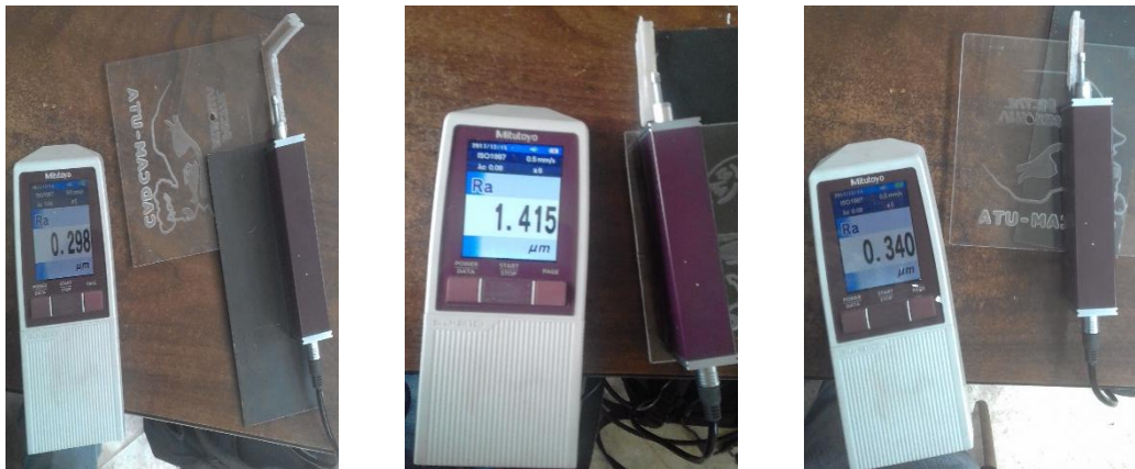
Figura 22 Toma de datos en el rugosímetro SJ-210 Mitutoyo de las ranuras en orden de izquierda a derecha: CFCV1,1-60/0,15/HSC, medición 3 - CFAV1,2-60/0,1/HSS, medición 1 - CFCV1,1-48/0,1/HSC, medición 2
