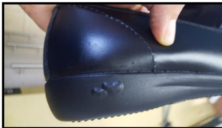
Figura 25. Roto por cardado/despegados. Realizado por: Diego Altamirano
