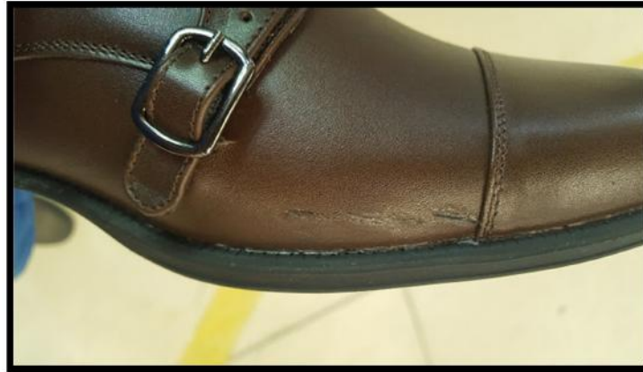
Figura 26. Desprendimiento de acabado Realizado por: Diego Altamirano
