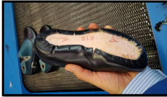
Figura 6. Corte armado en horma Realizado por: Diego Altamirano
