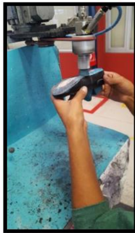
Figura 9. Operación Untado adhesivo Realizado por: Diego Altamirano
