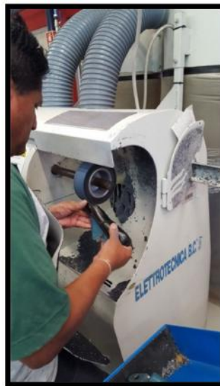
Figura 7. Operación de Cardado de acabado Realizado por: Diego Altamirano
