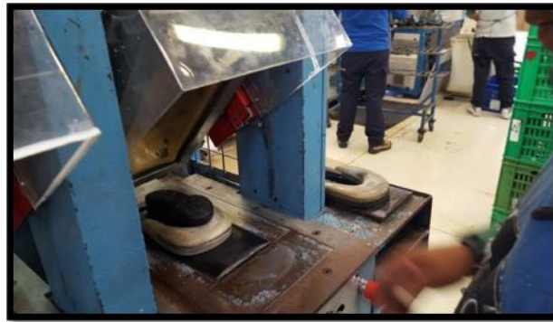
Figura 11. Pegado suela y corte en equipo Realizado por: Diego Altamirano
