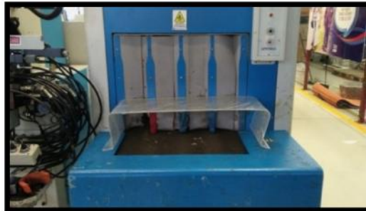
Figura 40. Construcción de protector Realizado por: Diego Altamirano
