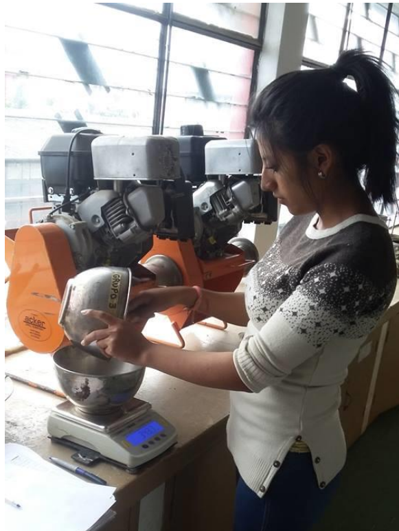
Fotografía 11. Pesar muestra de suelo.
