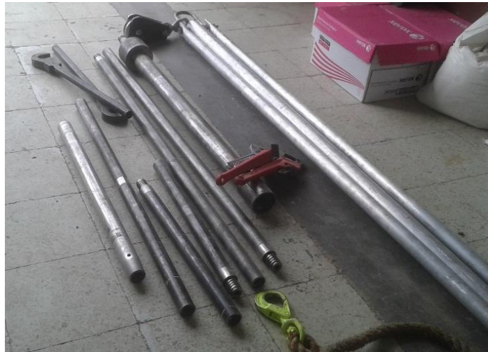
Fotografía 1. Equipo utilizado para realizar el Ensayo de Penetración Estándar (SPT) tales como martinete, trípode, tubos redondos, acoples, cabo de manila, muestreador.
