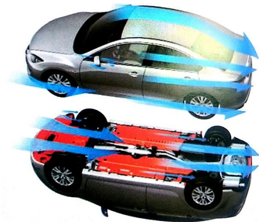
Figura 2.4 Flujo exterior de aire
