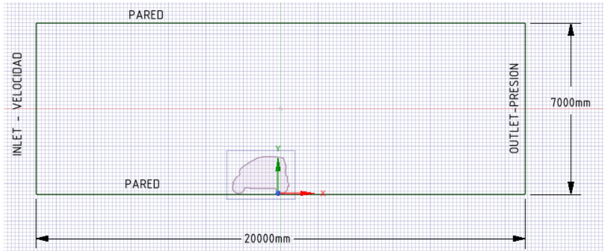
Fig. 2.30: Condiciones de Frontera y medidas de volumen de control Fuente: LosAutores
