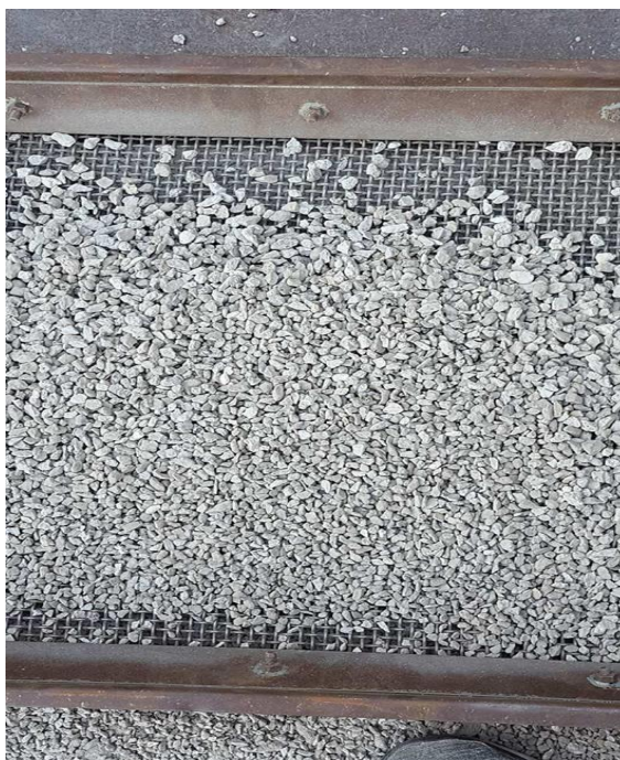
Imagen 6. Material empleado como cama filtrante
