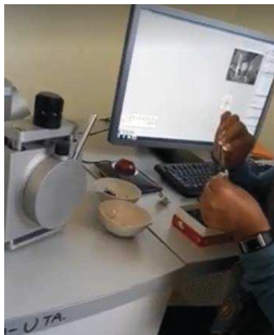
Imagen 11. Caracterización del bagazo de la caña de azúcar en la maquina microscopio electrónico de barrido (SEM)
