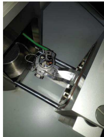
Muestras colocadas en el microscopio electrónico TESCAN
