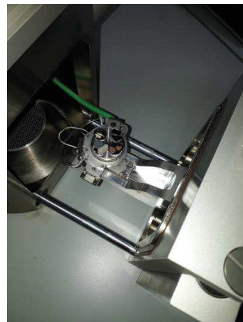
Imagen 11. Caracterización del bagazo de la caña de azúcar en la maquina microscopio electrónico de barrido (SEM)
