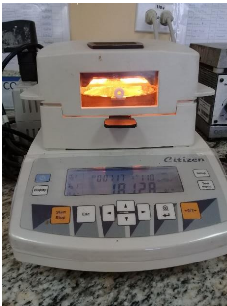
Anexo 4. Determinación de sólidos totales usando balanza de humedad. Mediante determinación del porcentaje de humedad se establece la relación para obtener la cantidad de sólidos totales.
