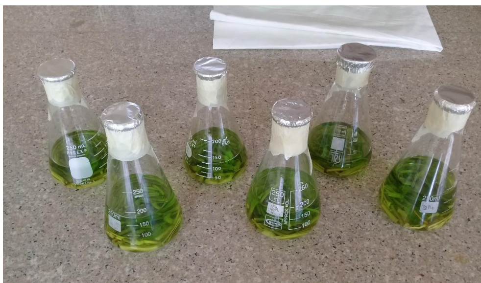
Figura 4. Proceso de maceración. Este proceso se llevó a cabo bajo agitación cada dos días para homogenizar la muestra con el disolvente y aumentar la superficie de contacto
