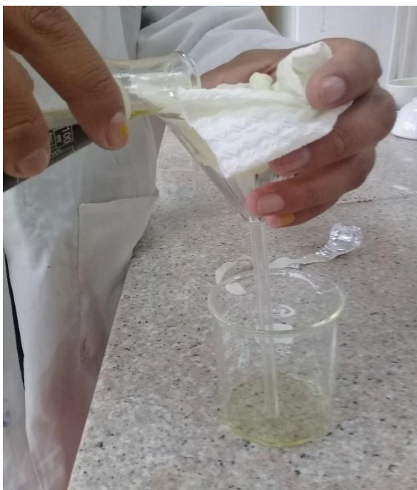
Figura 6. Filtración del extracto concentrado. En el matraz se observa el extracto concentrado con una coloración verde oscura, al pasarla por el lienzo se observa una pérdida de coloración debido a la detención de sólidos en el filtro
