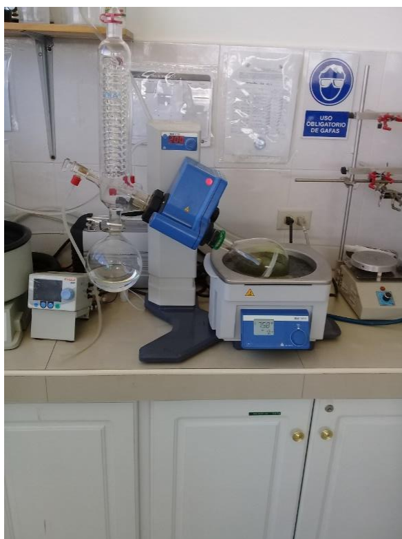
Anexo 5. Concentración de la solución madre empleando un rotaevaporador.
