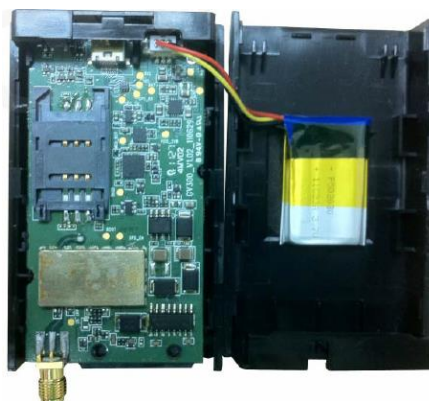
Fig. 4.14 Instalación batería interna de respaldo [36]
