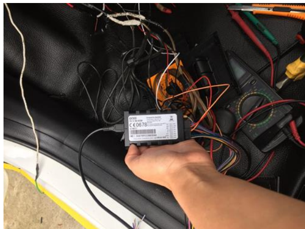
Fig.4.31 Instalación finalizada del equipo GV300 en el auto Fuente: Investigador
