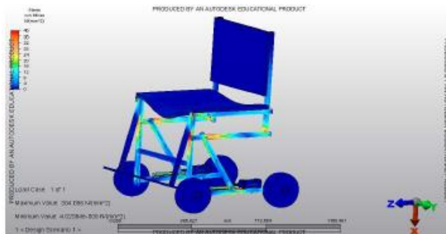
Figura No. 2. 5 Simulación de esfuerzos de silla bipedestadora por elementos finitos
