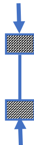
Figura No. 6. 23 Diagrama de cuerpo libre de las columnas pertenecientes a la estructura inferior Elaborado por: El Investigador
