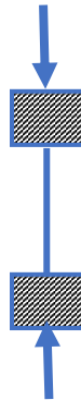
Figura No. 6. 20 Diagrama de cuerpo libre del eslabón Elaborado por: El Investigador
