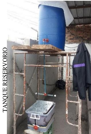
**Foto 3:** Estructura completa del filtro de turba
