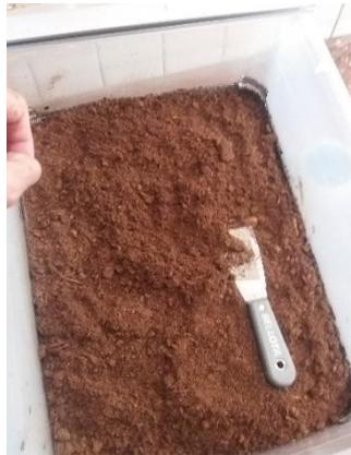
**Foto 1:** Colocación de material en filtro
