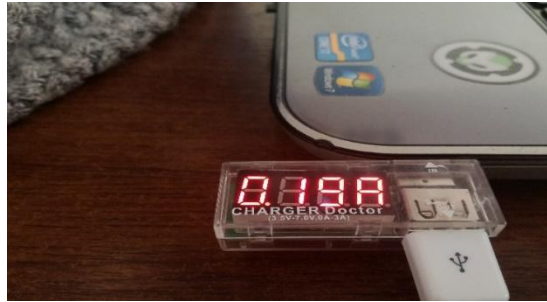
Fig. 50. Medición de consumo energético con Charger Doctor.
