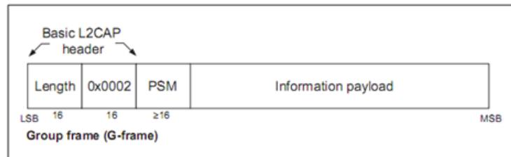
Fig. 14. Formato del paquete L2CAP BLE [21].
