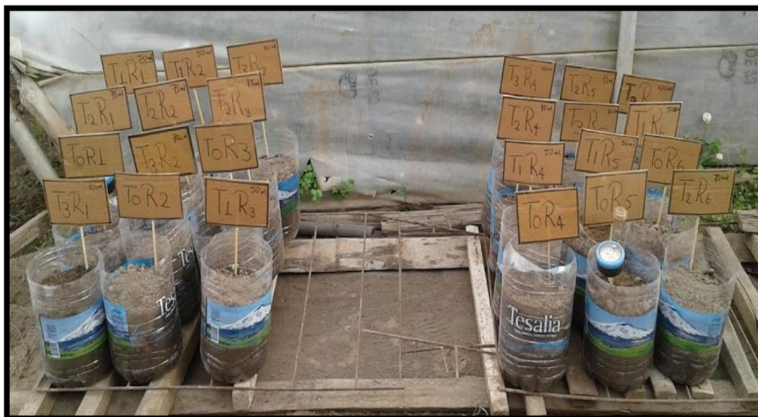
Figura 6: Colocación de macetas y tensiómetro
