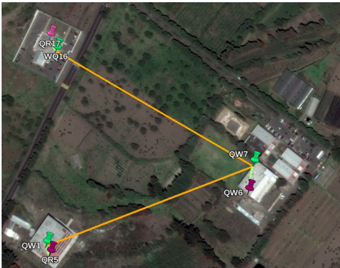
Fig.4. 14: Radio-enlace de corto alcance entre los bloques de edificios del campus Querochaca. . [Google Earth]
