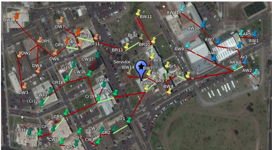
Fig.4. 11: Diagrama de conexión de los radios Ubiquiti en el campus Huachi. [Google Earth]
