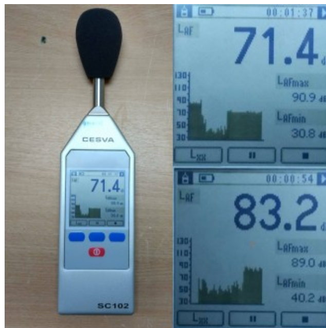
Fig.4. 46: Mediciones de nivel de presión sonora realizadas en la FISEI-UTA. Elaborado por Investigador
