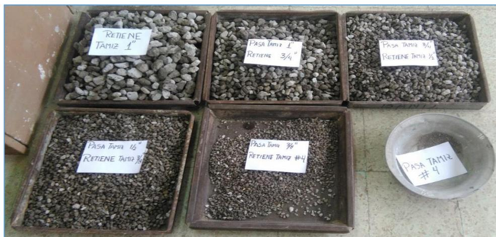
**Figura 4.** Ensayo de Granulometría de la Piedra Pómez, 2017.
