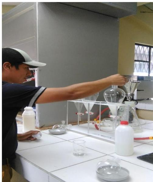
**Imagen 23.** Colocación de 1 ml de Ácido Sulfúrico.
