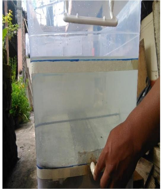
**Imagen 15.**Prueba de filtración con 35 litro de agua.
