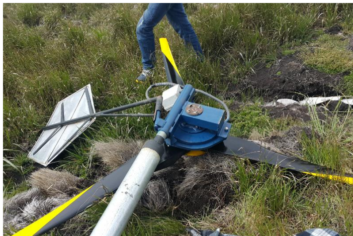
Montaje de la veleta de orientación al conjunto álabes-rotor
