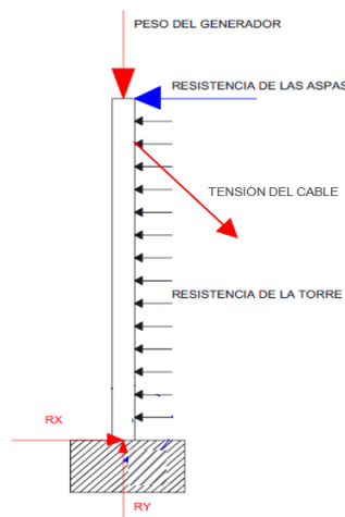
Fig. 43 Diagrama de cuerpo libre con cargas y restricciones incluyendo el cable tensor.
