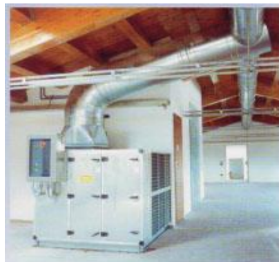
Figura 2-7. Horno Deshumidificador de secado de madera [18].
