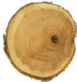
Gráfico N.º 6: Estructura de la madera: Médula
