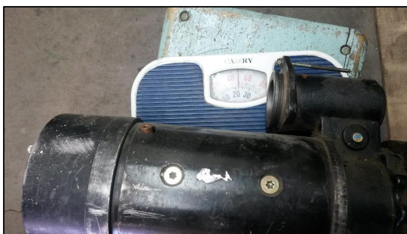
Fig. 15 Determinación de la masa real del motor de arranque
