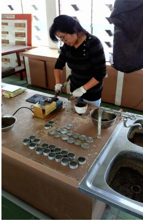
FOTO N°7. Colocación de la muestra en la Copa Casagrande.
