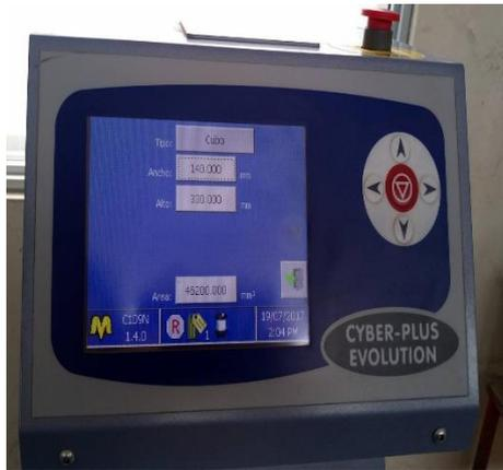
FOTO N°15. Digitación de medidas de los ladrillos en la máquina de compresión
