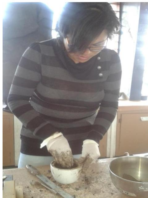
FOTO N°6. Mezcla de arcilla con la sustitución parcial de lodo
