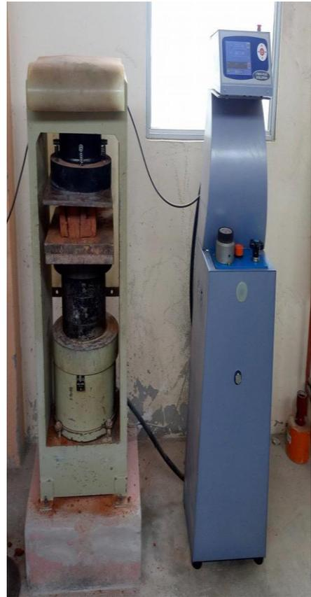
FOTO N°17. Ensayo a compresión del ladrillo
