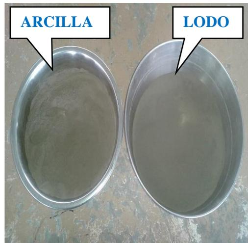
FOTO N°4. Muestras para Ensayo Límite Líquido y Plástico
