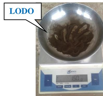
FOTO N°5. Peso de arcilla y lodo para Ensayo Límite Líquido y Plástico
