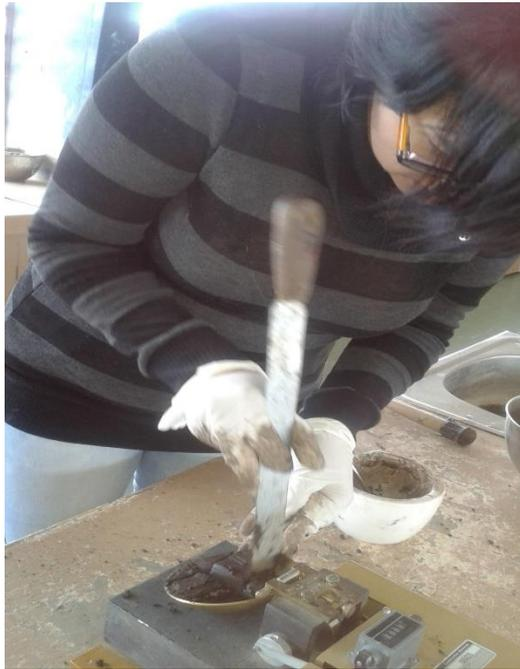
FOTO N°10. División de la muestra para el ensayo de límite líquido.
