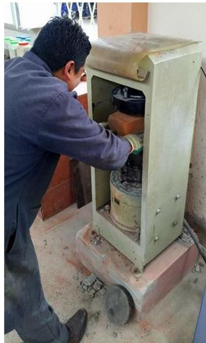
FOTO N°16. Colocación del ladrillo en la máquina de compresión
