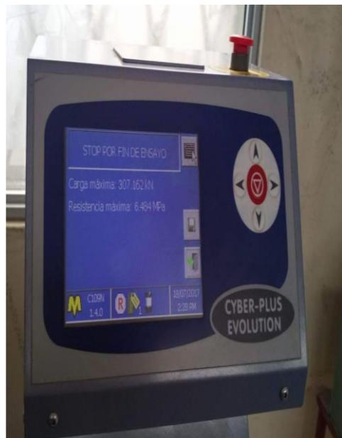
FOTO N°18. Datos de carga máxima y resistencia máxima del ladrillo.
