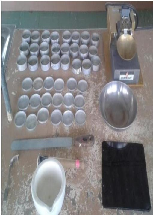
FOTO N°3. Materiales para Ensayo Límite Líquido y Plástico
