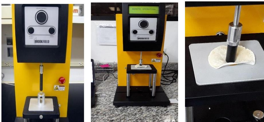
**Figura 9.** Equipo utilizado y adaptaciones realizadas para determinar el perfil de textura de las tortillas de maíz nixtamalizado.
