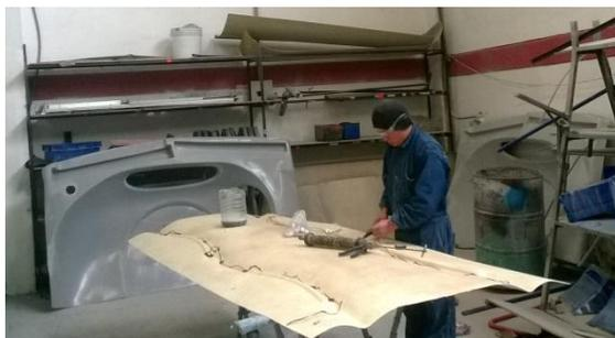
Figura N°.30. Fotografía de preparación de fibras
