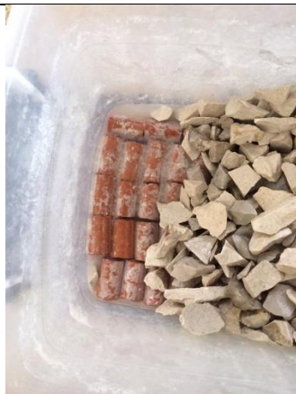
Foto 27. Estado de materiales después de filtración, piedra caliza y canutillos de cerámica.
