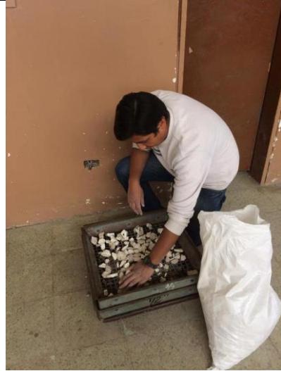
Foto 12. Tamizado de piedra caliza (Tamiz 3/4" y 1/2")
