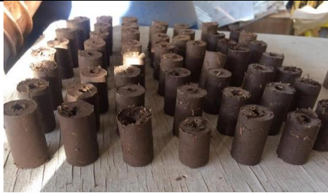
Foto 13. Canutillos de cerámica (etapa de secado)
