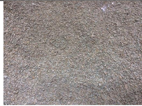
Foto 18. Zeolita con granulometría de 1-3mm
