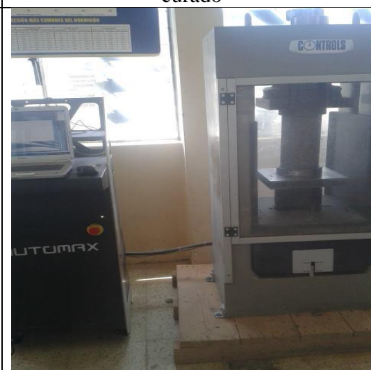
Ensayo de Resistencia a la Compresión
