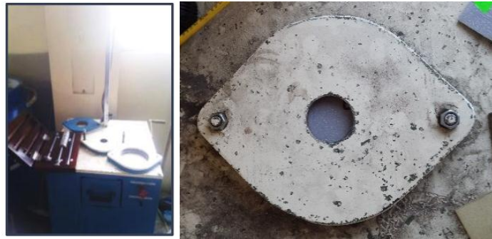
Figura 3.34 Colocación de las probetas en las abrazaderas de la máquina de ensayo
