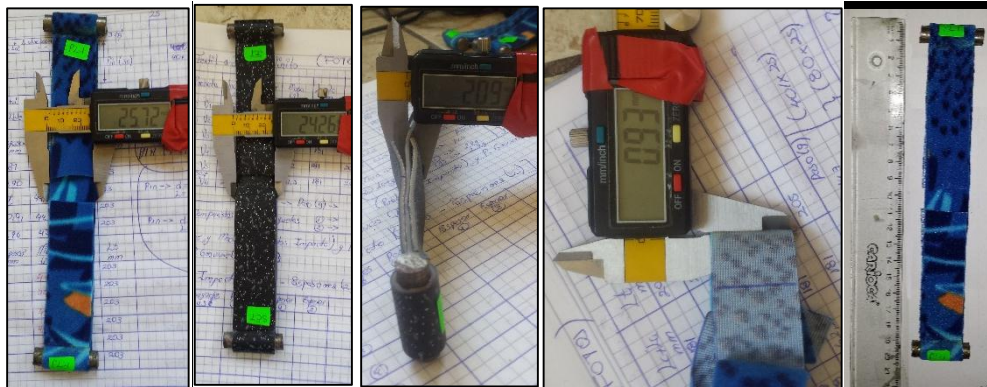
Figura 3.26 Medición de probetas de materiales textiles
