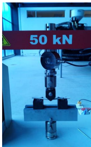
Figura 3.32 Colocación de las probetas en el puente de flexión
