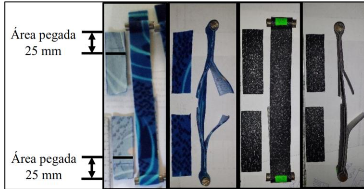
Figura 3.23 Pegado de las lengüetas en las probetas
