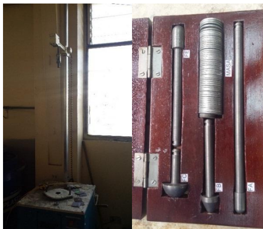
Figura 3.33 Máquina y equipo para ensayo de impacto de dardo
