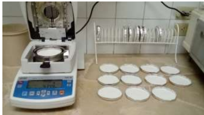
Figura 48. Determinación de Humedad
