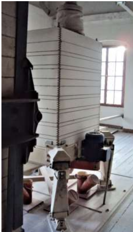
Figura 44. a Sifter de seguridad; b Plansifter
