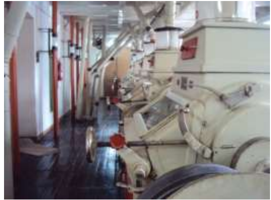
Figura 43. a Centrifuga de harina de trigo; b Bancos de Molienda
