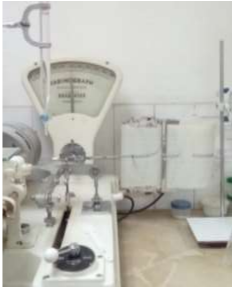
Figura 50. Ensayo de farinografía
