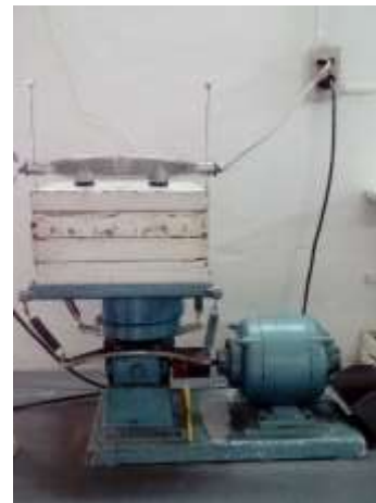
Figura 49. Ensayo de Granulometría
