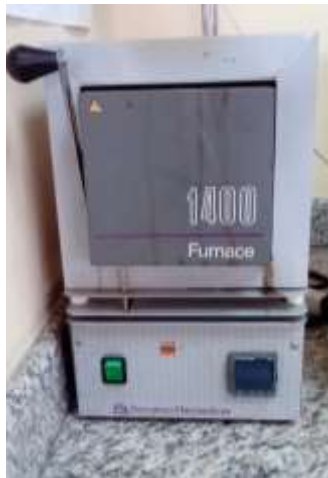
Figura 51. Determinación de cenizas
