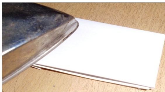
Figura 159. Planchado del circuito electrónico con la baquelita Fuente: Investigador
