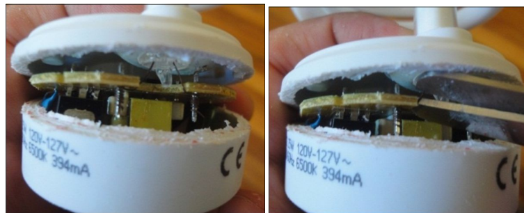
Figura 51. Corte de alambres unido a la posición de filamentos en el foco de 25 W Fuente: Sylvania
