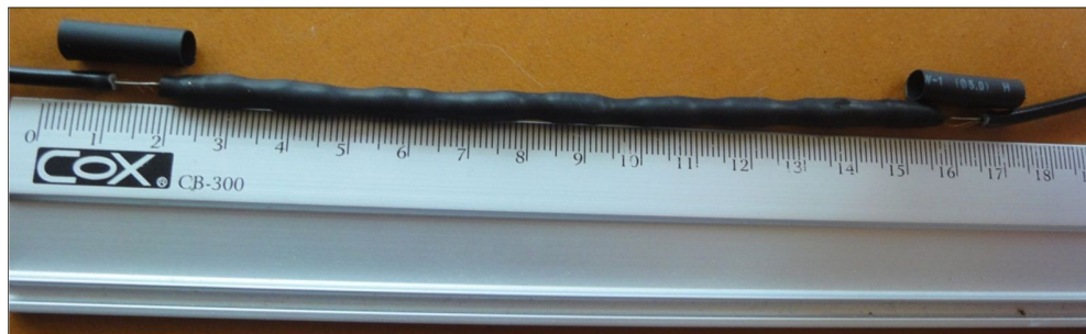
Figura 147. 2 Trozos pequeños de thermofit en cada terminal y la medida que debe tener el thermofit más grande
