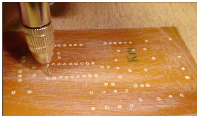
Figura 163. Perforaciones con taladro en baquelita Fuente: Investigador
