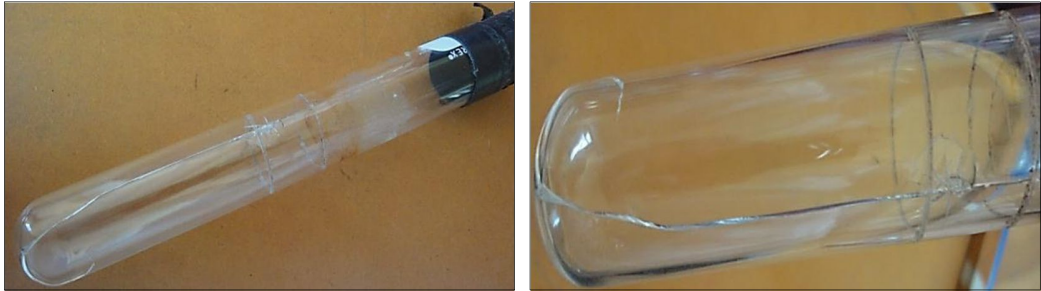
Figura 32. Fisuras en el tubo de ensayo correspondiente a la 1ra prueba de corte Fuente: Instruequipos
