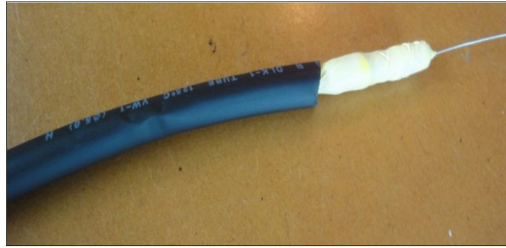
Figura 144. Resistencias soldadas con cinta teflón dentro del Thermofit Fuente: Investigador
