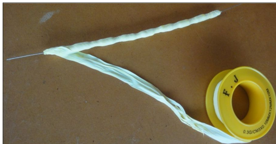
Figura 143. Unión de resistencias envueltas con cinta teflón Fuente: Investigador
