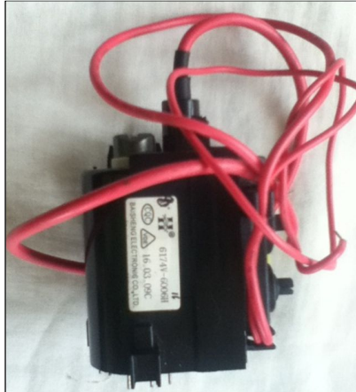
Figura 14. Modelo externo de un transformador flyback Fuente: Baisheng electronic LTD.
