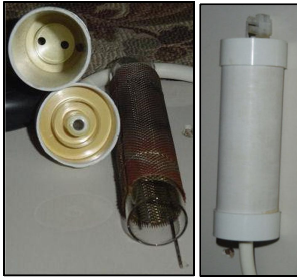
Figura 8. Celda generadora de ozono [25]
