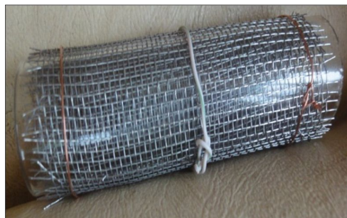
Figura 38. Tubo de vidrio revestido con malla de aluminio interna y externamente Fuente: Investigador
