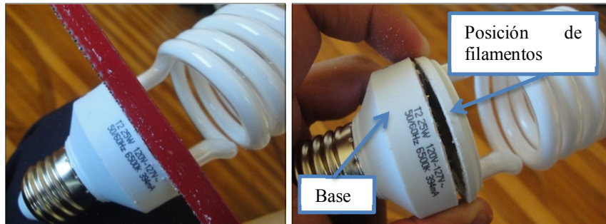
Figura 50. Corte del foco de 25 W entre la base y la posición de filamentos Fuente: Sylvania
