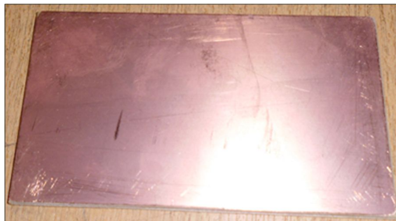
Figura 158. Baquelita cortada y lijada Fuente: Investigador
