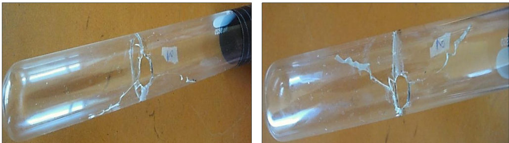
Figura 33. Fisuras en el tubo de ensayo correspondiente a la 2da prueba de corte Fuente: Instruequipos
