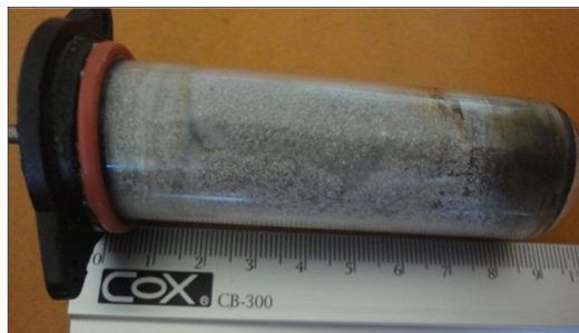
Figura 21. Dimensión del vidrio circular de una celda generadora usada Fuente: DelZone
