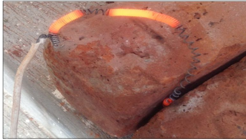
Figura 30. Funcionamiento irregular de la resistencia en espiral 1000w Fuente: Investigador
