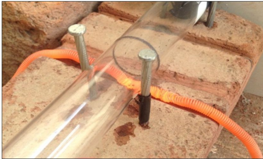
Figura 34. Giro del tubo de ensayo en la 3ra prueba de corte Fuente: Instruequipos
