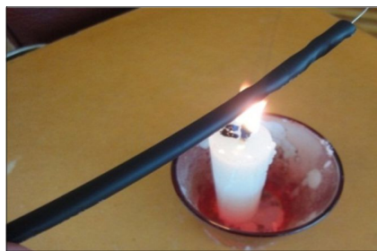
Figura 145. Thermofit contraído a alta temperatura Fuente: Investigador
