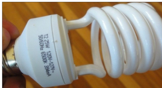
Figura 49. Foco ahorrador de potencia = 25 W Fuente: Sylvania
