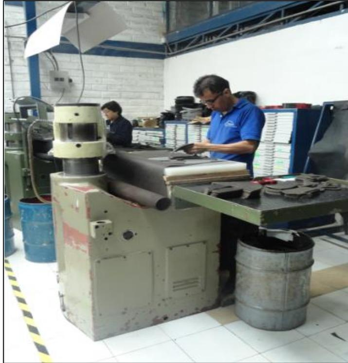
Fig. 8 Proceso de troquelado del calzado de cuero
