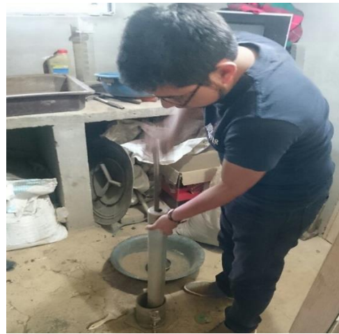
Foto N° 16.- Compactación de la Muestra
