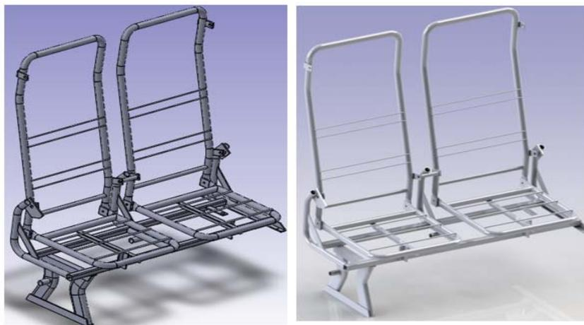
**Figura 3. 6.** Modelo digital de la estructura del asiento. (Fuente: Autor)
