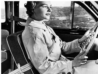
**Figura 2. 10.** Cinturón de seguridad de dos puntos torácico. [15]
