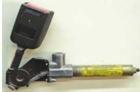
**Figura 2. 7.** Pretensor de cinturón de seguridad. [12]
