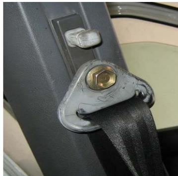
**Figura 2. 8.** Pretensor de cinturón de seguridad. [12]
