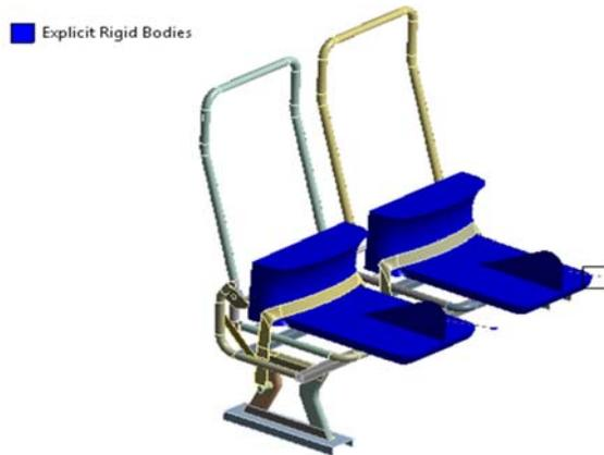
**Figura 3. 15.** Cuerpos totalmente rígidos en los bloques de tracción. (Fuente: Autor)
