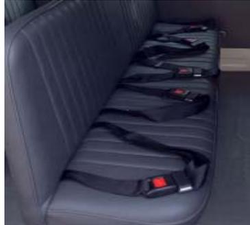
**Figura 2. 9.** Cinturón de seguridad de dos puntos pélvico. [12]
