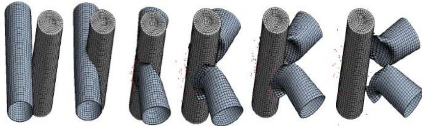
**Figura 2. 23.** Análisis dinámico explícito de un impacto a alta velocidad.
