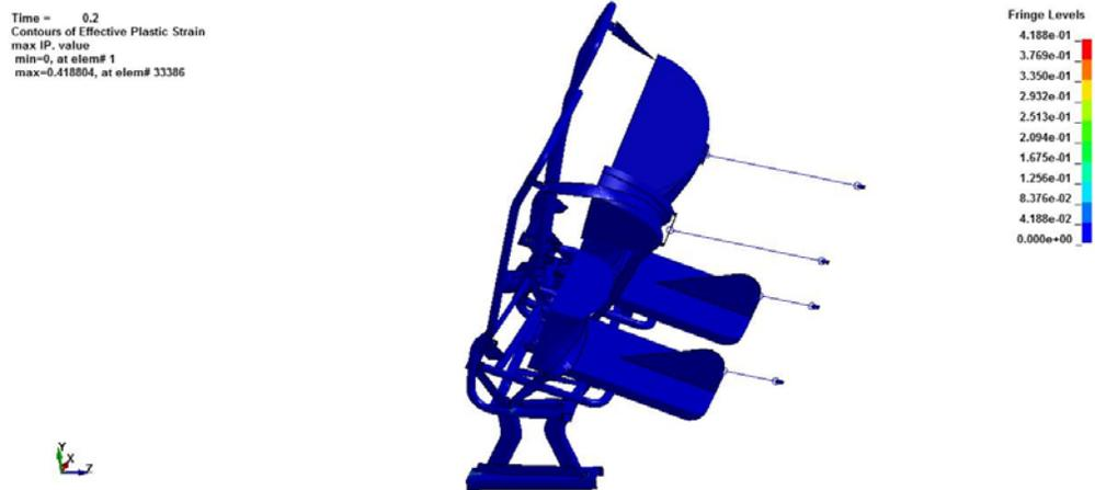
**Figura 4. 116.** Deformación plástica efectiva máxima en la estructura. (Fuente: Autor)
