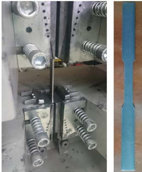
**Figura 3. 7.** Ensayo de tracción de acero ASTM A36. (Fuente: Autor)
