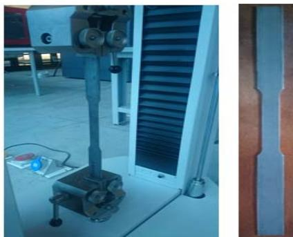
**Figura 3. 9.** Ensayo de tracción de acero ASTM A500 grado A. (Fuente: Autor)
