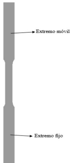
**Figura 4. 5.** Modelo digital para el ensayo de tracción de acero ASTM A36.
