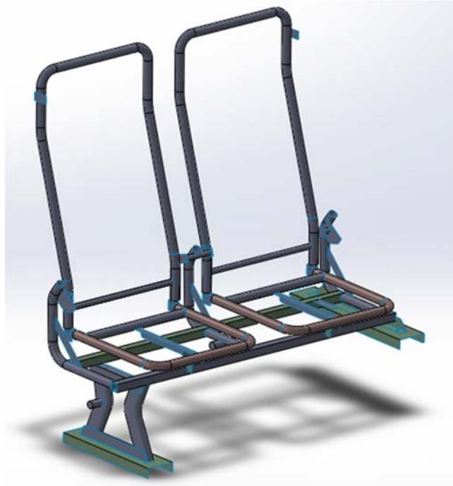
**Figura 3. 11.** Modelo simplificado de la estructura del asiento. (Fuente: Autor)
