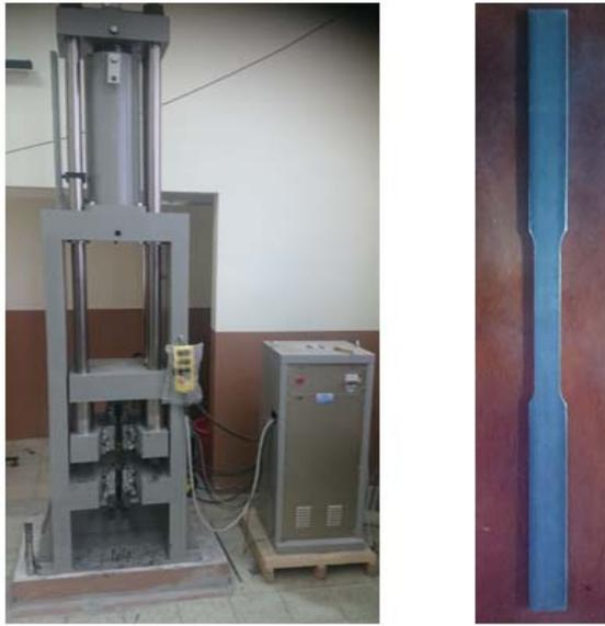
**Figura 2. 38.** Máquina para ensayo de tracción y espécimen normalizado.
