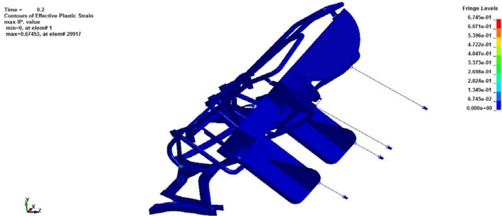
**Figura 4. 58.** Deformación plástica efectiva máxima en la estructura. (Fuente: Autor)
