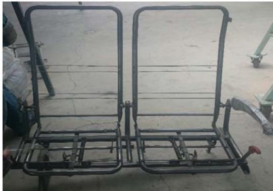
**Figura 3. 3.** Estructura de asiento de autobús interprovincial fabricada por MIVILTECH Soluciones Industriales S. A. (Fuente: Autor)
