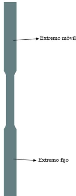
**Figura 4. 13.** Modelo digital para el ensayo de tracción de acero ASTM A500.
