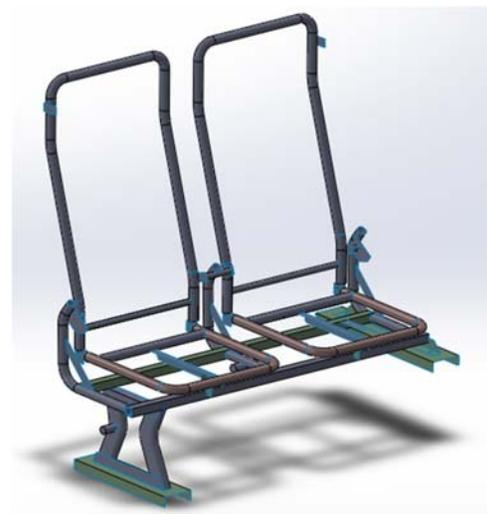
**Figura 7.** Modelo simplificado de la estructura del asiento. (Fuente: Autor)
