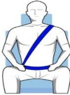
**Figura 2. 11.** Cinturón de seguridad de tres puntos. [12]
