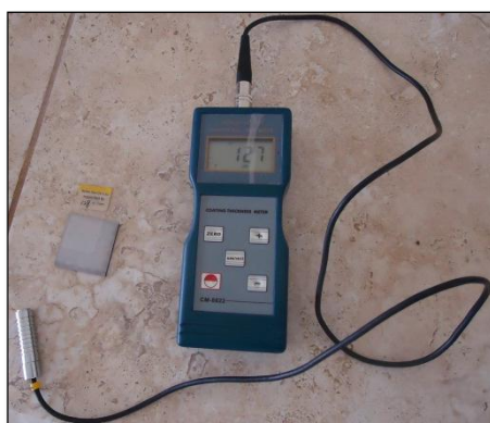
Figura 6. Equipo portátil de medición de espesor por ultrasonido.
